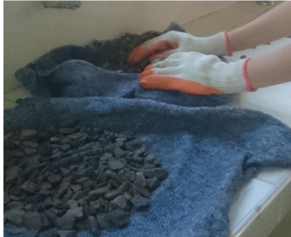
Fotografía 7. Realización del ensayo de peso específico del agregado grueso, grava \frac{3}{4} "
