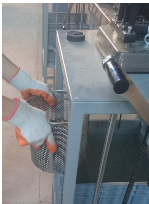
Fotografía 6. Realización del ensayo de peso específico del agregado grueso, grava 3/4"
