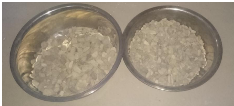
Fotografía 3 Muestra en ensayo de desgaste en máquina de Los Ángeles.
