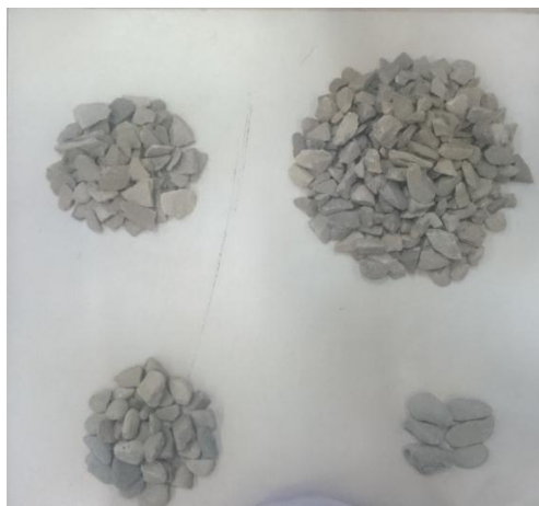
Fotografía 1. Ensayo de caras fracturadas
